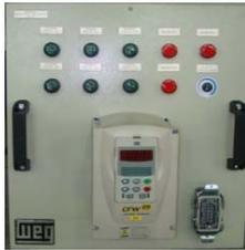
Módulo Convertidor Frecuencia CFW09
