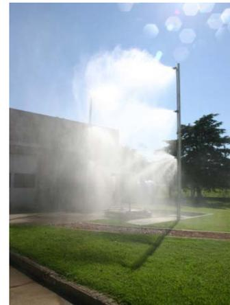
En un dispositivo construido especialmente a tal fin, por medio de 6 aspersores se rocían como mínimo 5mm/min de agua durante un tiempo de 5 min (aprox. 25mm de precipitación en toda la prueba). No debiendo advertirse presencia de agua en las partes eléctricas, ni aislaciones de los circuitos principales y auxiliares; además el gabinete y otras partes externas no deben retener agua que favorezca la corrosión.
