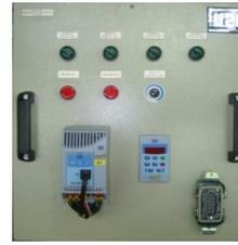
Módulo Convertidor Frecuencia CFW08
