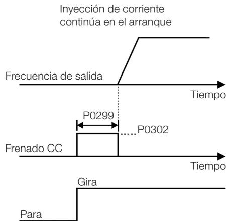
Figura 11.8: Actuación del Frenado CC en el arranque
