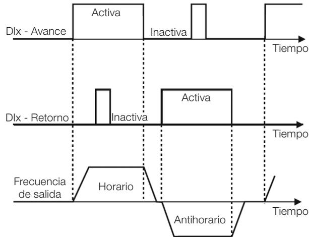
**Figura 12.9:** Ejemplo de la función Avance / Retorno
