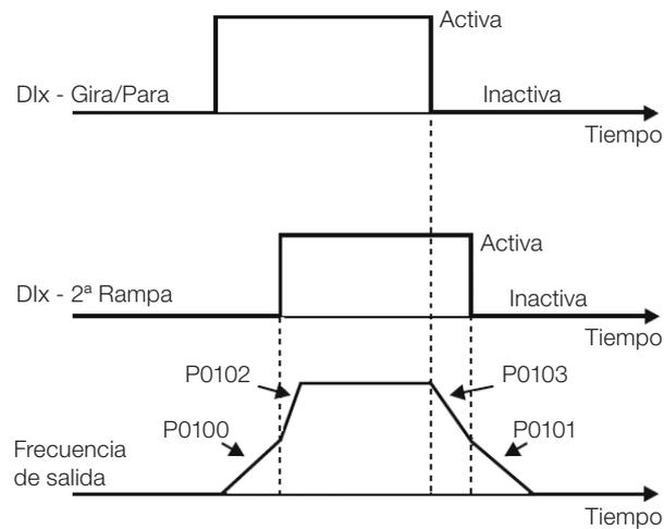
Figura 12.14: Ejemplo de la función 2ª Rampa
