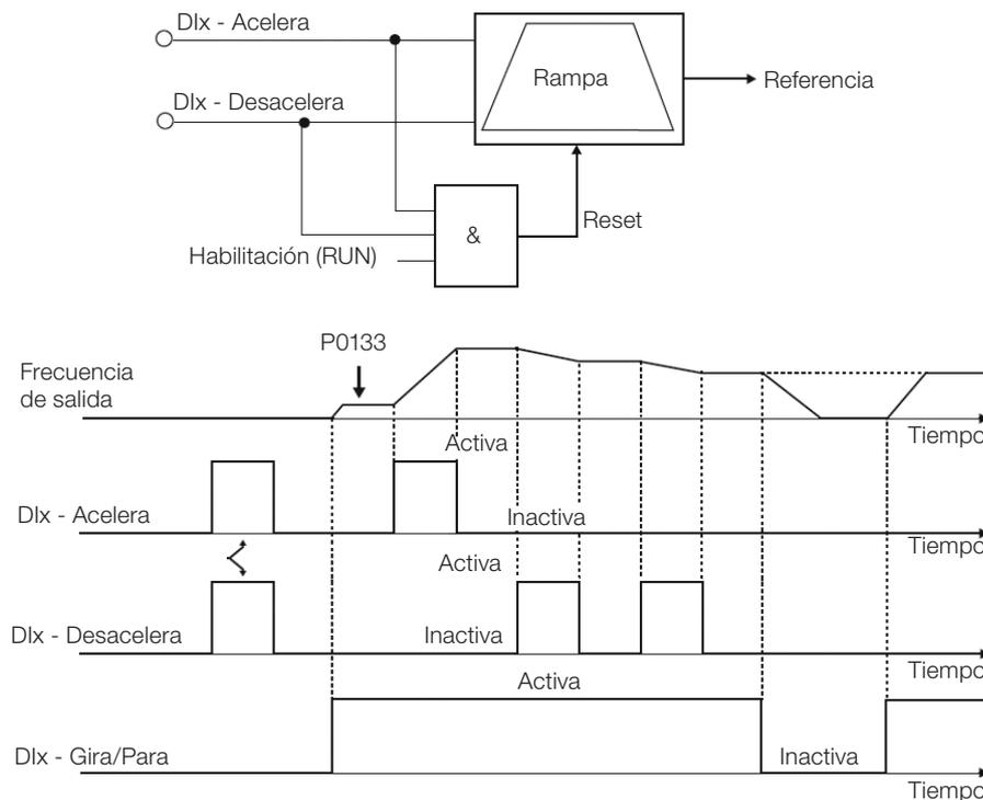
**Figura 12.13:** Ejemplo de la función Potenciómetro Electrónico (E.P.)
