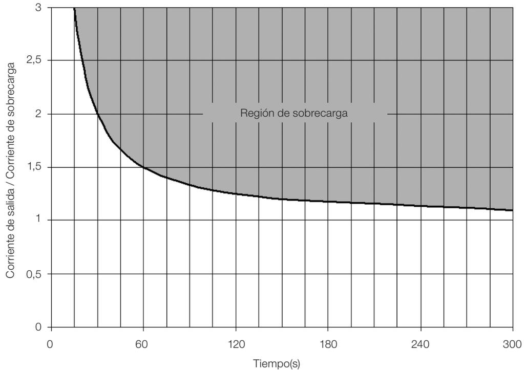
**Figura 15.1:** Actuación de la sobrecarga del motor
