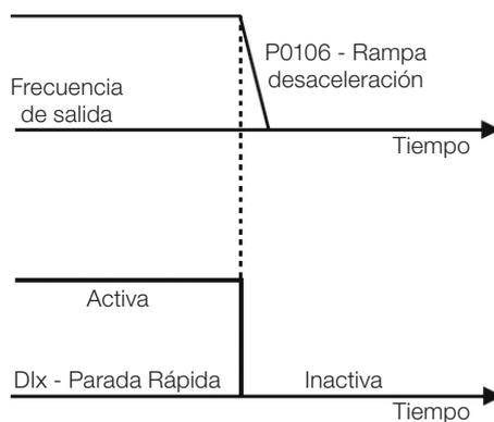
Figura 12.8: Ejemplo de la función Parada Rápida
