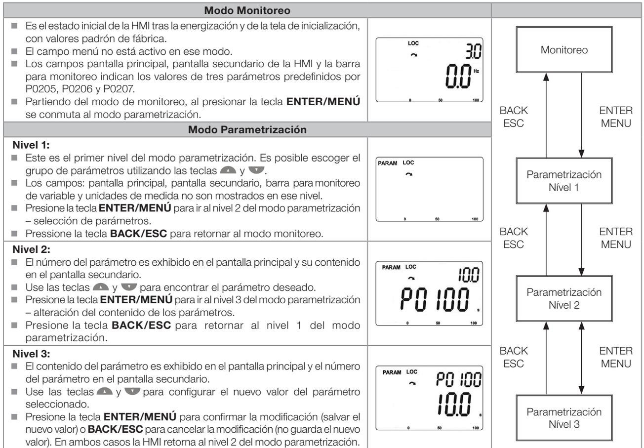
Figura 4.3: Modos de operación de la HMI
