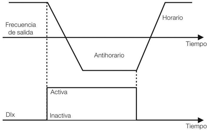
Figura 12.11: Ejemplo de la función Sentido de Giro
