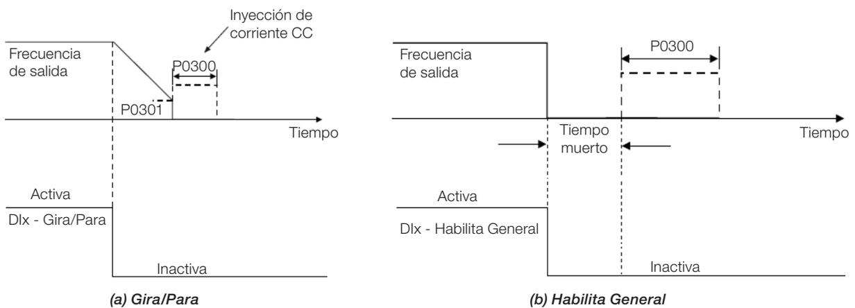
Figura 11.9: (a) y (b) Actuación del Frenado CC
