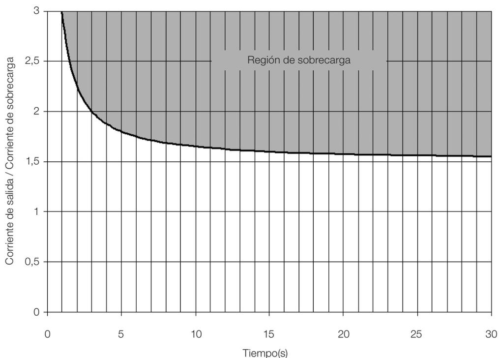
**Figura 15.2:** Actuación de la sobrecarga de los IGBTs
