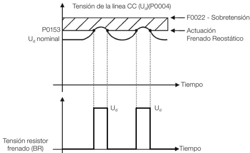
**Figura 14.1:** Curva de actuación del Frenado Reostático
