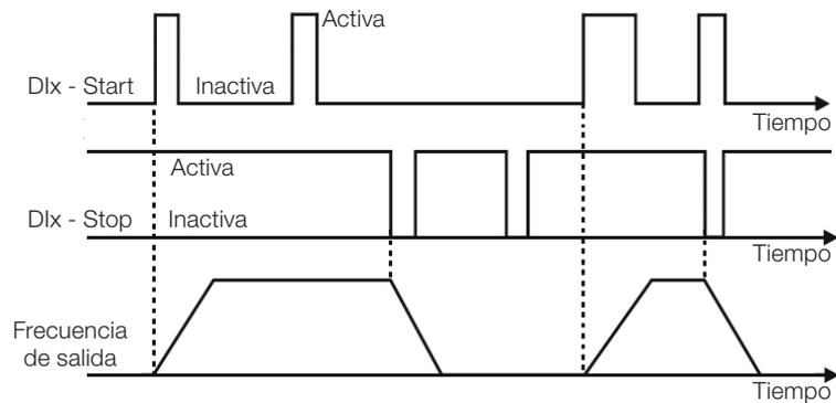
**Figura 12.10:** Ejemplo de la función Start / Stop tres hilos
