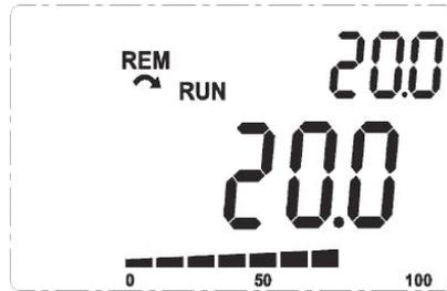
Figura 13.3: Ejemplo de la HMI en modo monitoreo para la utilización del regulador PID
