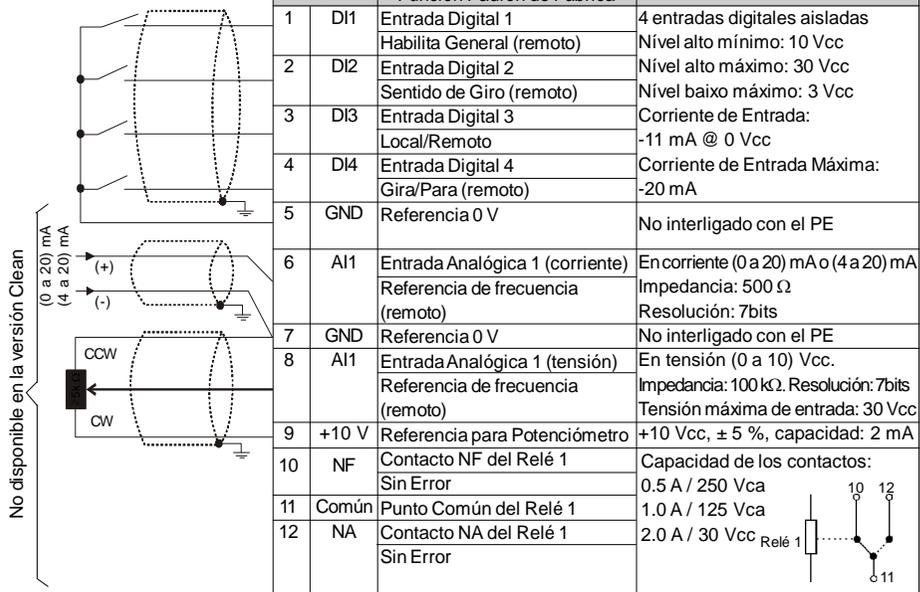
Figura 3.8 - Descripción del conector XC1 de la tarjeta de control
